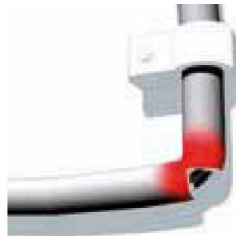
Стареене на защитната обвивка на кабела
